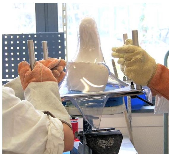
Thermoformage par emboutissage profond d'une prothèse de bras
