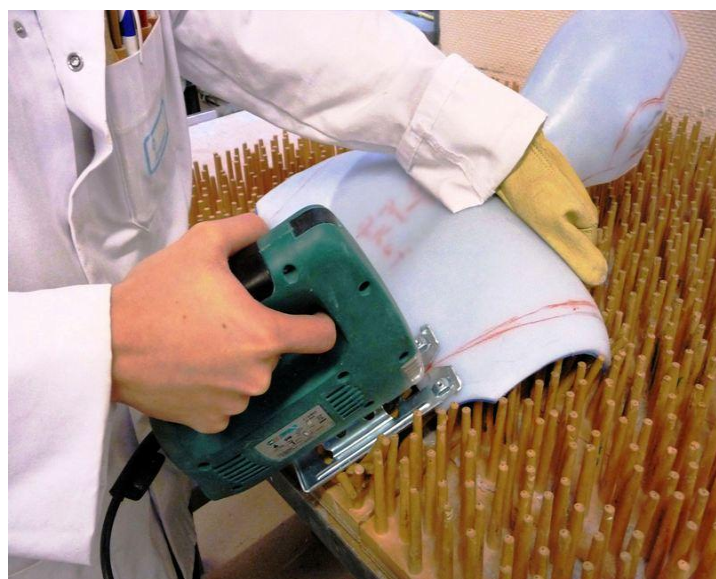
Découpe d'une minerve à la scie sauteuse
